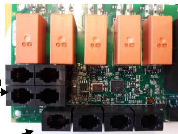
Rysunek 6 . Kolejność złączy RJ 10. Czujnik, przełącznik drzwiowy, sterowanie zdalne, dodatkowe NTC
